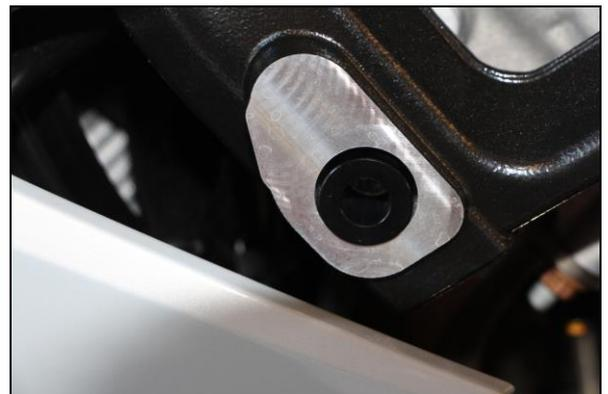
Posizionare la piastra di base/il supporto tra il telaio con la rondella e la vite in dotazione.
