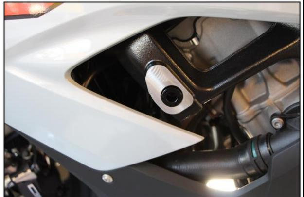
Posizionare la piastra di base/il supporto sul telaio del veicolo.
