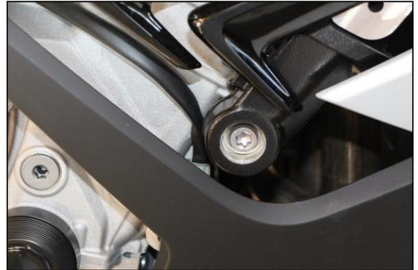
Inserire le viti a testa cilindrica con rondelle in dotazione attraverso la piastra di base / il supporto, inserire i dispositivi anti-torsione nella scanalatura e fissarli in modo che possano essere spostati.
