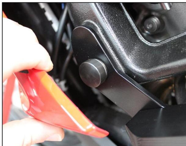
Pulire l'incavo del cuscinetto e inserire l'adesivo, premendolo saldamente in posizione.
