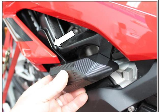
Inserire la piastra di base/staffa nel punto di montaggio posteriore del motore nel foro e nel punto di montaggio anteriore con la rondella e avvitare il telaio a -60 Nm.
