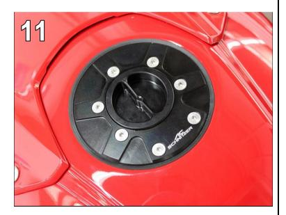
Vérifier que les vis de fixation sont bien serrées.
