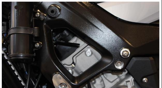
Desserrer et retirer les deux vis de support du moteur sur le côté droit (elles ne seront pas réutilisées).
