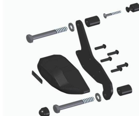
Retirer les vis de fixation du revêtement sur les côtés **droit et gauche**. Retirer le caoutchouc de la vis et le presser sur le rouleau d'écartement fourni.
