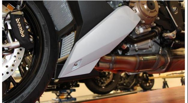
Desserrer et retirer complètement le revêtement intérieur à gauche et à droite.
