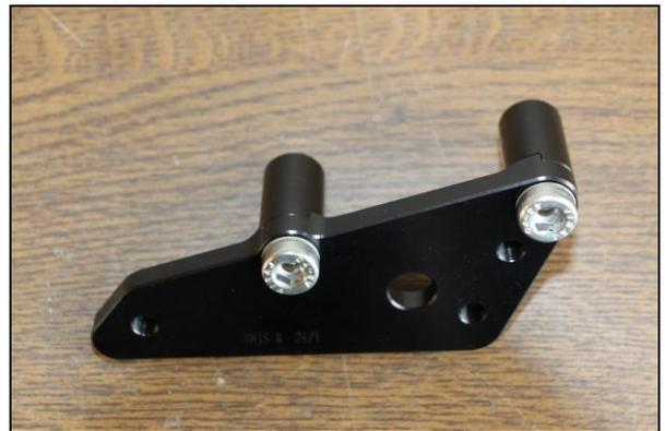
Insérer la douille d'écartement jointe dans le cadre.
