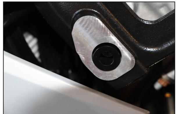
Placer la plaque de base / le support entre le cadre avec la rondelle et la vis fournies.
