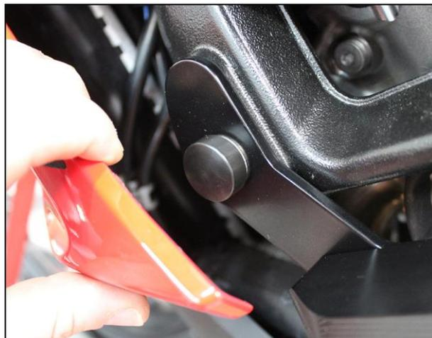
Nettoyer le renforcement du pad, y placer l'autocollant et appuyer fermement.
