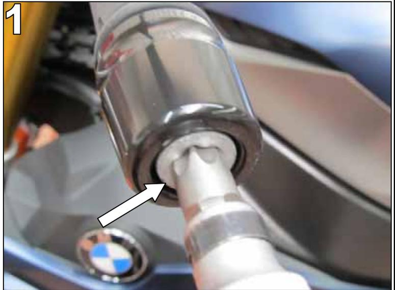
Dévisser la vis de fixation de l'armature de l'accouplement
