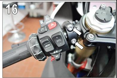
Rabattre la lèvre de la poignée, dévisser la vis de fixation exposée avec un tournevis Torx et la retirer.
