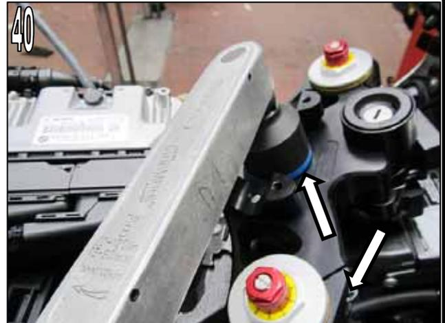
Poussez l'unité électrique gauche sur le guidon AC Schnitzer fourni, insérez le guidon dans les supports de serrage, centrez-les et serrez les supports de serrage uniformément. Appliquez au préalable de la colle à vis sur les vis. Couple de serrage final : 25Nm. (Fig. 41)
