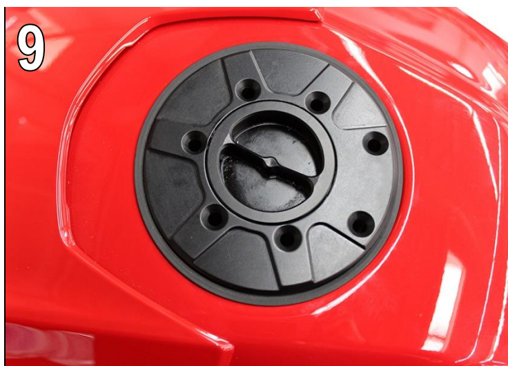
Fig. 9 Introduzca el tapón del depósito de combustible AC Schnitzer en el depósito. Alinee la junta del anillo exterior y el tapón del depósito de combustible AC Schnitzer.
