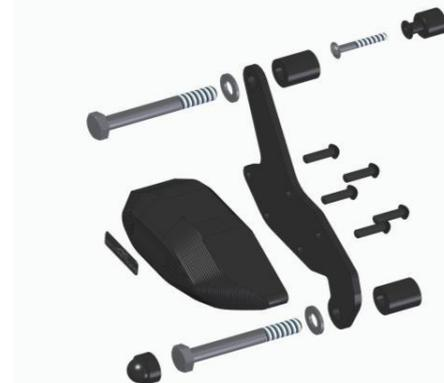
Retire el tornillo de sujeción del carenado del lado derecho e izquierdo. Extraiga la goma del tornillo y presiónela sobre el rodillo distanciador adjunto.
