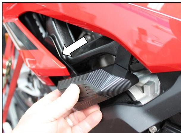
Inserte la placa base / soporte en el punto de montaje trasero del motor en el agujero y en el punto de montaje delantero con la arandela y atornille en el bastidor -60 Nm.
