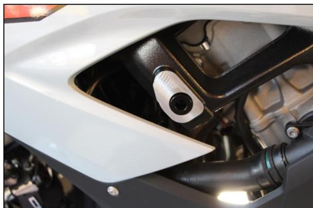
Coloque la placa base / soporte en el bastidor del vehículo.
