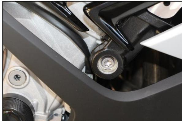
Inserte los tornillos de caperuza adjuntos con arandelas a través de la placa base / soporte, inserte los dispositivos antirrotación en la ranura y fíjelos de modo que aún se puedan mover.
