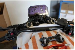
Afloje los dos tornillos de bloqueo que sujetan las contratuercas bajo el puente de la horquilla.
