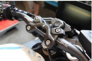
Coloque con cuidado el manillar sobre el depósito mientras saca el soporte del cable de embrague de las abrazaderas.
