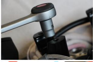
Inserte el soporte del cable de embrague y el manillar en las abrazaderas
