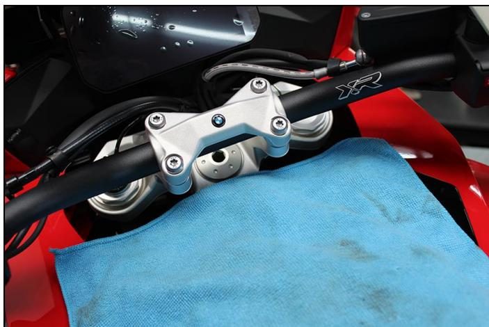
Afloje los cuatro tornillos de fijación de la abrazadera del manillar en sentido antihorario.
