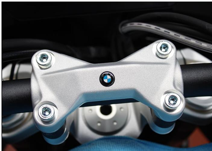
Inserte el manillar, alinéelo con las marcas del manillar y coloque la abrazadera del manillar.
