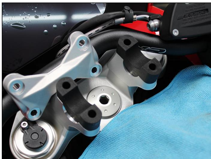
Inserte los elevadores de manillar AC Schnitzer suministrados en la parte inferior del orificio de sujeción del puente de la horquilla.
