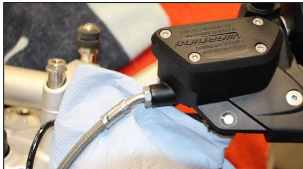
Scaricare il liquido della frizione dal serbatoio o dall'intero sistema secondo le specifiche di fabbrica.
