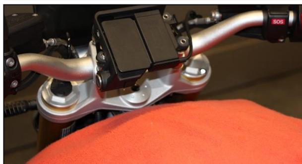
Svitare le viti di fissaggio del supporto per il sistema di navigazione in senso antiorario e rimuoverlo dal lato della guida in gomma.
