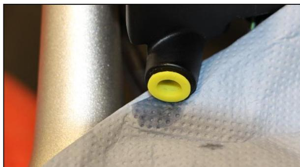
Chiudere il cilindro della frizione con il tappo di plastica in dotazione.
