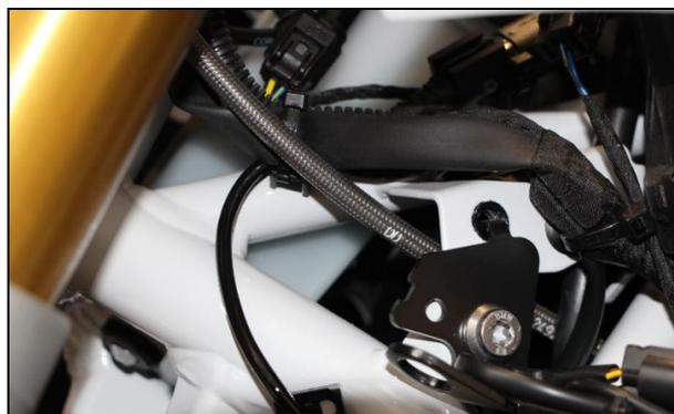
Allentare le quattro viti di fissaggio del manubrio in senso antiorario e rimuoverle.
