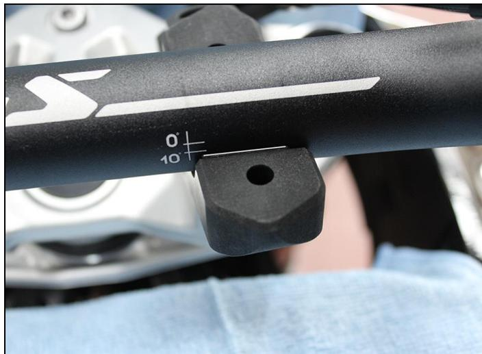
Enduire les vis de fixation de série de frein-filet "à résistance moyenne" et les visser.
