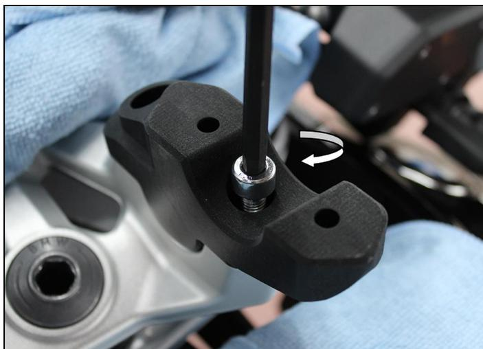
Enduire les vis de fixation M8x25mm livrées avec du frein-filet "moyennement solide" et les serrer. les visser à fond.
