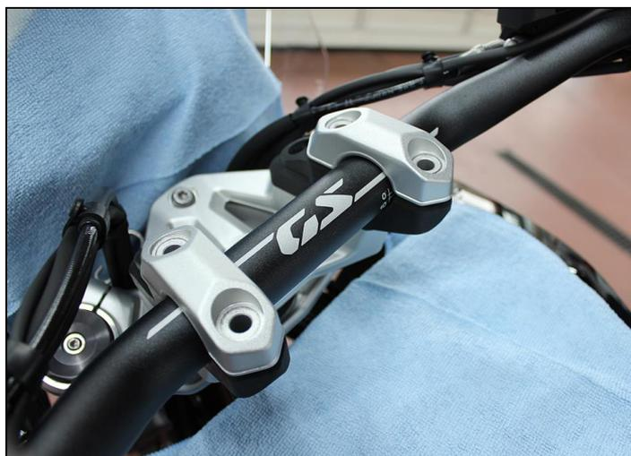
Serrer le guidon, y compris les supports de serrage du guidon.
