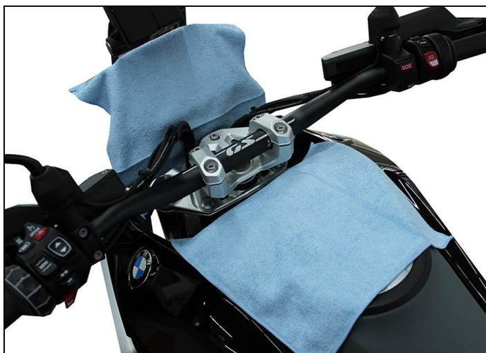
Dévisser les quatre vis de fixation des supports de guidon dans le sens inverse des aiguilles d'une montre.
