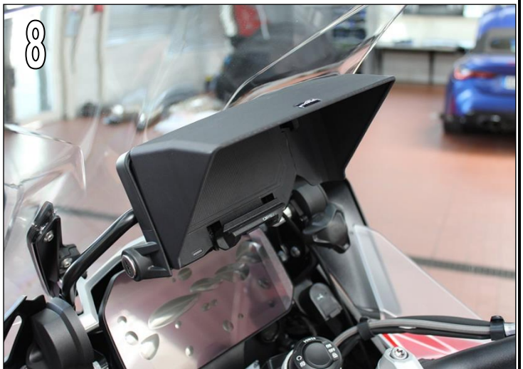
Fig. 8 & 9 Inserte el protector antideslumbrante AC Schnitzer con soporte Connected Ride en el soporte de navegación.
