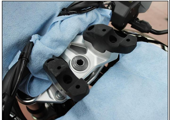
Inserte los elevadores de manillar AC Schnitzer suministrados en las bases del puente de la horquilla/agujero de sujeción.
