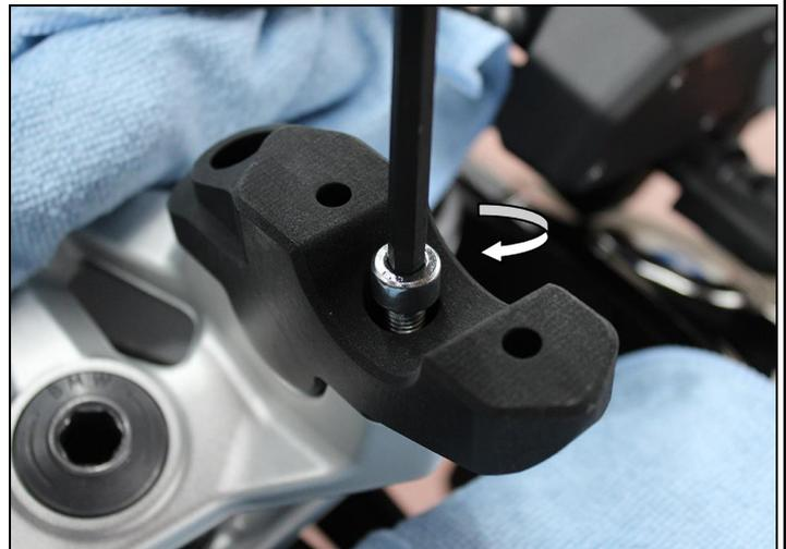
Aplique fijador de roscas "de resistencia media" a los tornillos de fijación M8x25mm suministrados y atorníllelos.
