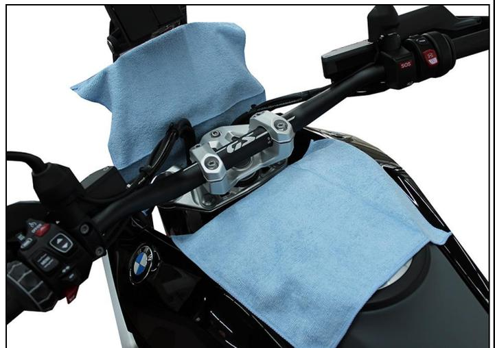
Afloje los cuatro tornillos de fijación de las abrazaderas del manillar en sentido antihorario.
