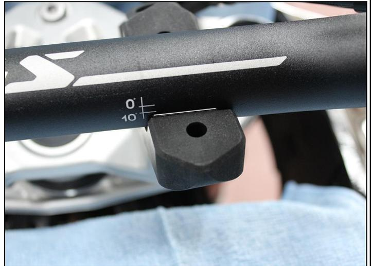
Aplice fijador de roscas de "resistencia media" a los tornillos de fijación estándar y atorníllelos.
