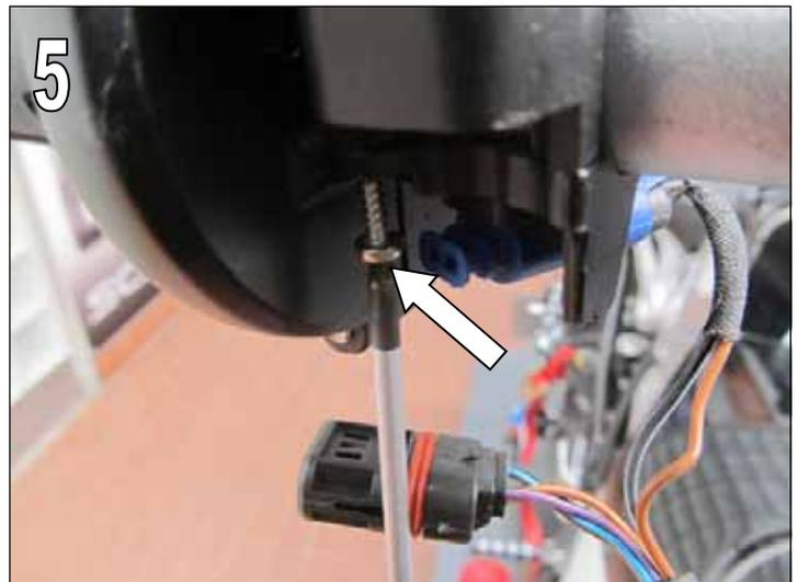
Dévisser complètement la vis de fixation de la poignée d'accélérateur. N'essayez pas encore de tirer sur la poignée des gaz ! (Fig. 6)
