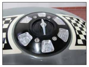
Bouchon de réservoir de carburant AC Schnitzer
