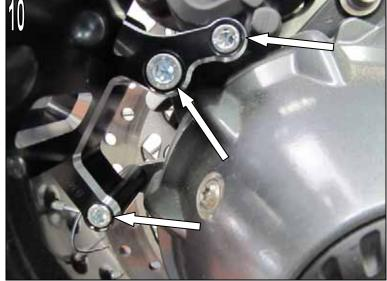
Montez les vis de fixation du support de plaque d'immatriculation avec les caches fournis.
