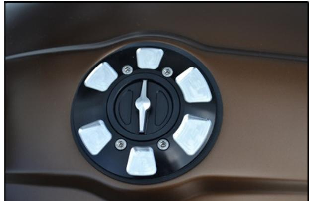
Couvercles de réservoir de liquide pour le côté embrayage et le côté frein. Anodisé puis fraisé.
