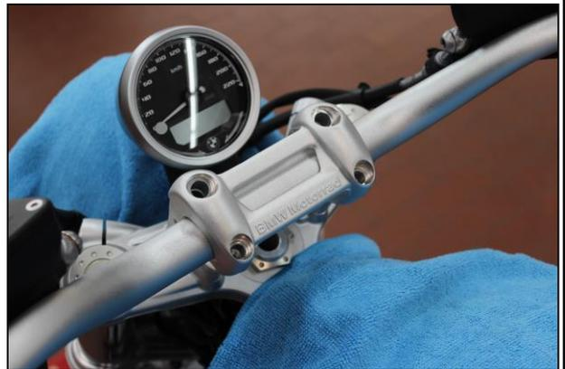
Coloque la parte superior de la abrazadera y apriete a mano los tornillos preparados.
