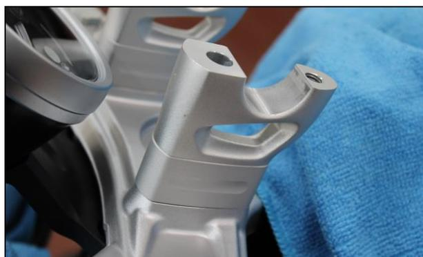
Aplice adhesivo para tornillos de "resistencia media" a los tornillos de fijación adjuntos.
