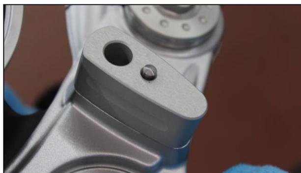
Coloque las bases de las abrazaderas originales en las bandas del manillar. en la contrahuella del manillar.
