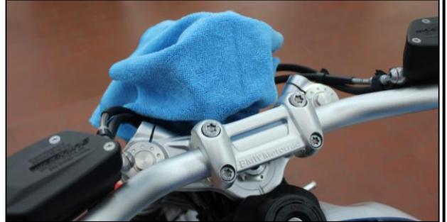
Afloje los cuatro tornillos de fijación del manillar en sentido contrario a las agujas del reloj y extráigalo.
