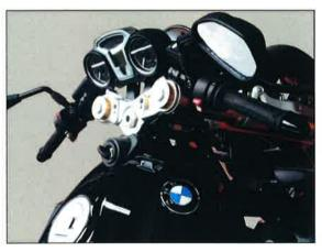
AC Schnitzer handlebar clip on (mit TÜV Teilegutachten) S217-67171-15
