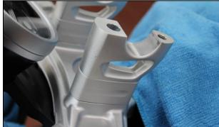
Placer les parties inférieures originales de la bride de serrage sur la hausse de guidon
