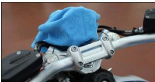
Dévisser les quatre vis de fixation du guidon dans le sens inverse des aiguilles d'une montre et les retirer.
