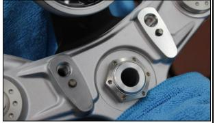
Insérer les rehausses de guidon AC Schnitzer livrées dans les goupilles cylindriques de série du té de fourche.
