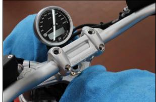
Poser la partie supérieure du Klemmbock et visser les vis préparées à la main.
