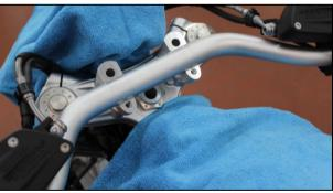
Retirer le guidon du tablier de la fourche et le déposer à l'abri de tout endommagement.
