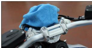
Afloje los cuatro tornillos de fijación del manillar en sentido contrario a las agujas del reloj y extráigalo.
