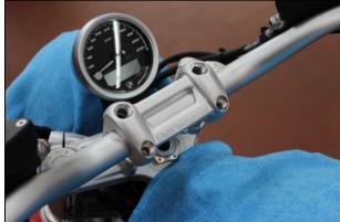
Coloque la parte superior de la abrazadera y apriete a mano los tornillos preparados.
