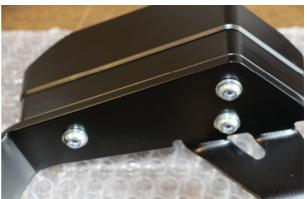
Insérez les douilles d'écartement jointes (avec le plus petit diamètre vers l'intérieur) dans le cadre.
