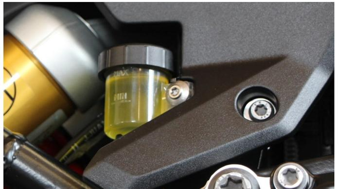
Fixer le support ci-joint avec les joints toriques, les vis
